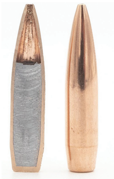
Rycina 3. Przekrój pocisku Hollow Point Boat Tail, Lapua Scenar .264, 123 gr. Źródło: https://reloaders.eu/lapua-scenar-a-good-hunting-bullet/ [13]
