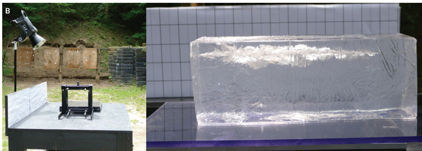
Rycina 2. A. Schemat poglądowy stanowiska badawczego (oprac. G. Motrycz). B. Blok żelatyny balistycznej na stanowisku badawczym. Fot. G. Motrycz / K.J. Helnarska
