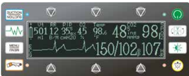
Rycina 2. Wyświetlacz modułu MOVES™. Skróty: B/M – oddechy na minutę, BP – ciśnienie tętnicze, CO 2 – prężność dwutlenku węgla, HR – częstotliwość tętna, O 2 – stężenie tlenu, PIP – szczytowe ciśnienie wdechowe, RR – częstotliwość oddechów, SpO 2 – saturacja, Temp – temperatura (na zdjęciu w stopniach Fahrenheita), Vt – objętość oddechowa. Za zgodą firmy Thornhill Research Inc.
