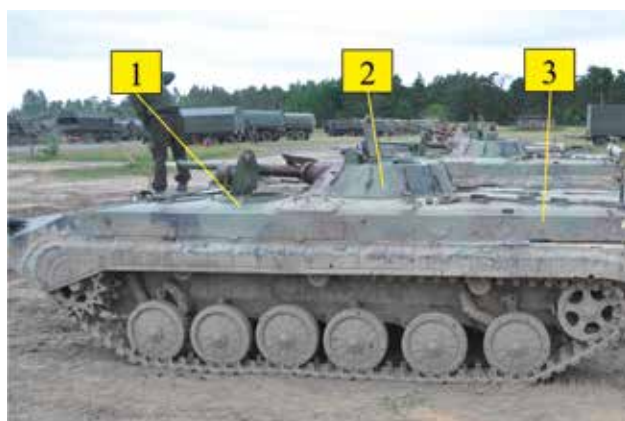
Rycina 3. Usytuowanie punktów pomiarowych w bojowym wozie piechoty BWP-1: 1 – komora dowódcy, 2 – komora działonowego, 3 – przedział desantu
