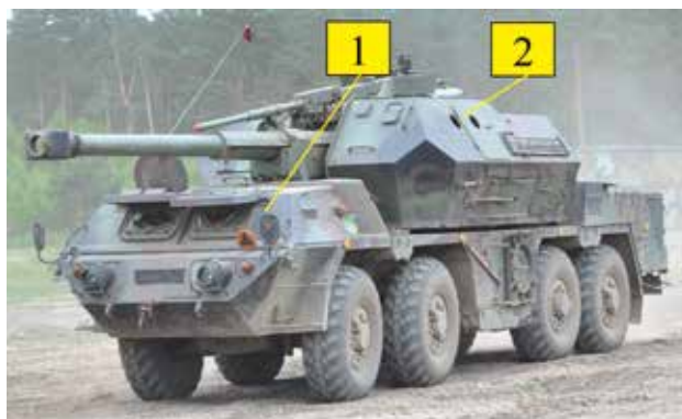
Rycina 2. Usytuowanie punktów pomiarowych w armatohaubicy Dana: 1 – kabina kierowcy, 2 – kabina celniczego
