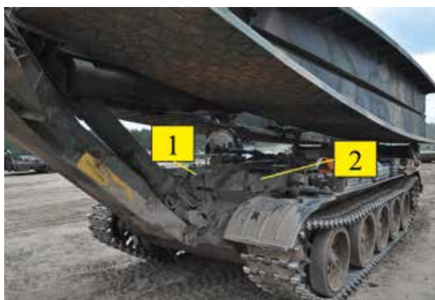
Rycina 4. Usytuowanie punktów pomiarowych w czołgu mostowym BLG-67: 1 – komora dowódcy, 2 – komora kierowcy
