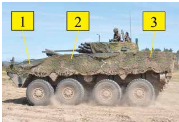
Rycina 1. Usytuowanie punktów pomiarowych w kołowym transportercie opancerzonym Rosomak: 1 – komora kierowcy, 2 – komora dowódcy, 3 – przedział desantu
