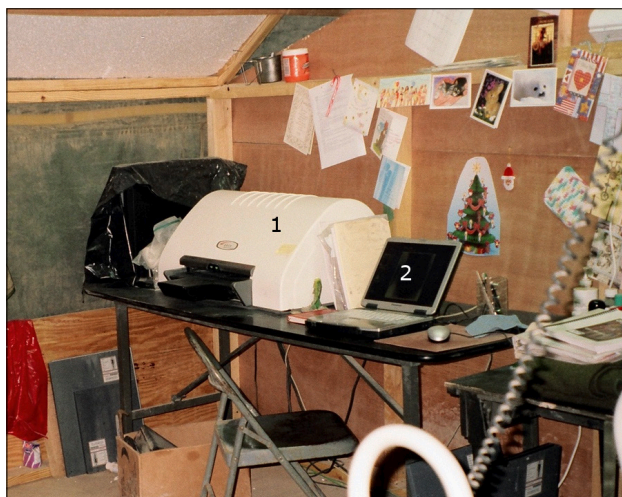
Rycina 15. Polowy Gabinet RTG w FST – Camp Babilon. (1) PcCR 1417 ACL4. (2) Komputer/monitor obrazów RTG (zdjęcie wykonane 12.12.2003) (źródło: materiał własny)
