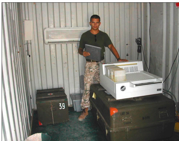
Rycina 12. Wywoływarka automatyczna AGFA Curix 69 postawiona na skrzyni transportowej w kontenerze–ciemni. Polski Szpital Polowy Polskiego Kontyngentu Wojskowego w składzie Sił Stabilizujących w Republice Iraku, Camp Lima k. Karbali, 2004–2008 (źródło: materiał własny)
