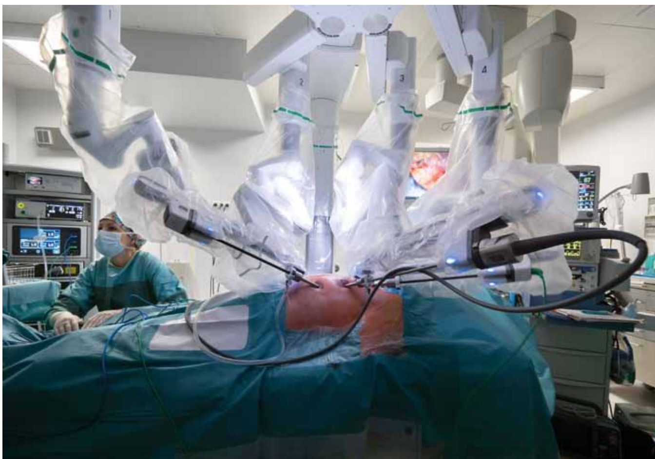
Ryc. 3. Robot da Vinci podczas operacji kardiologicznej w Centrum Chirurgii Robotycznej CSK MON WIM.
