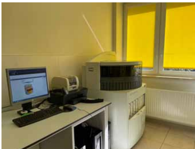
Rycina 3. System BenchMark ULTRA – zautomatyzowany system do badań immunohistochemicznych i hybrydyzacji in situ .
