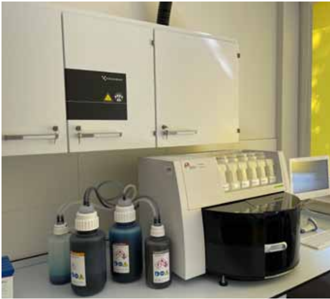
Rycina 1. Artisan Link Pro – aparat do barwień specjalnych.
