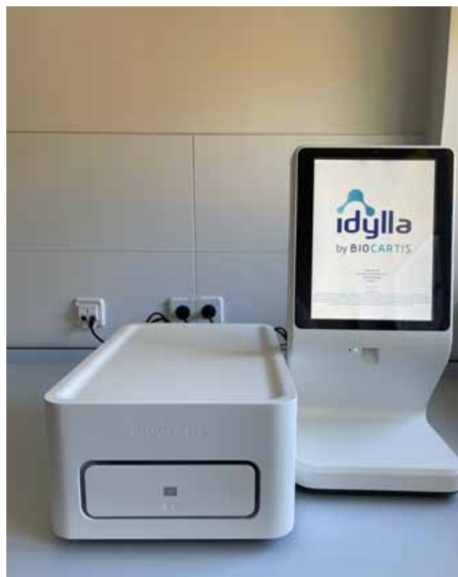
Rycina 4. System Idylla do wykrywania mutacji genetycznych m.in. w raku jelita grubego, czerniaku oraz raku płuca.
