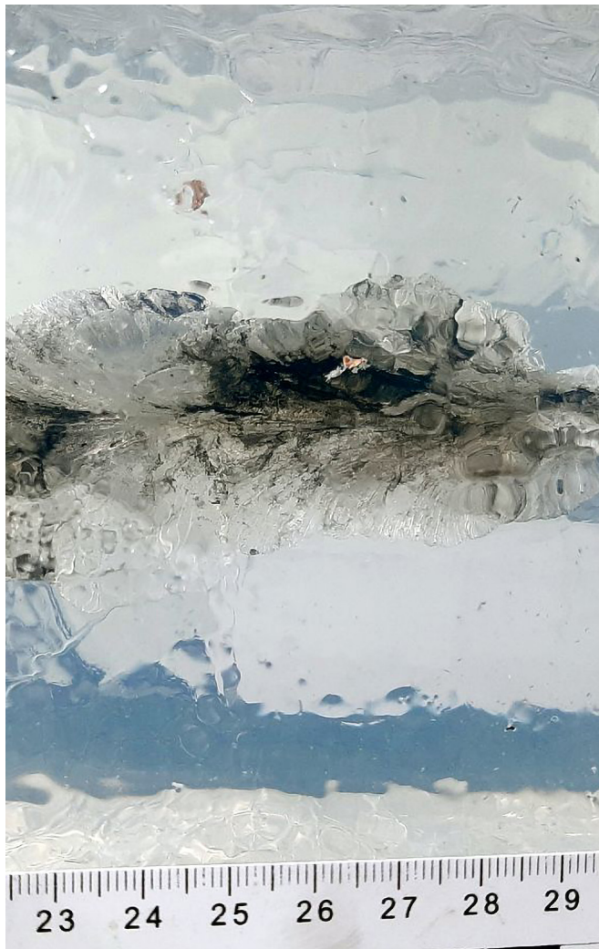
Rycina 4. Widok kanału trwałego w balistycznej żelatynie syntetycznej pocisku kalibru .308 Win. Fot. G. Motrycz
